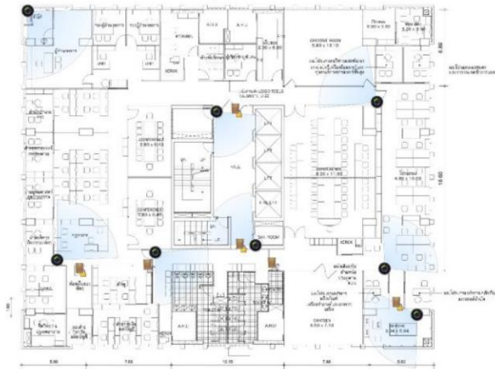
รูปแสดงจุดการติดตั้ง CCTV
